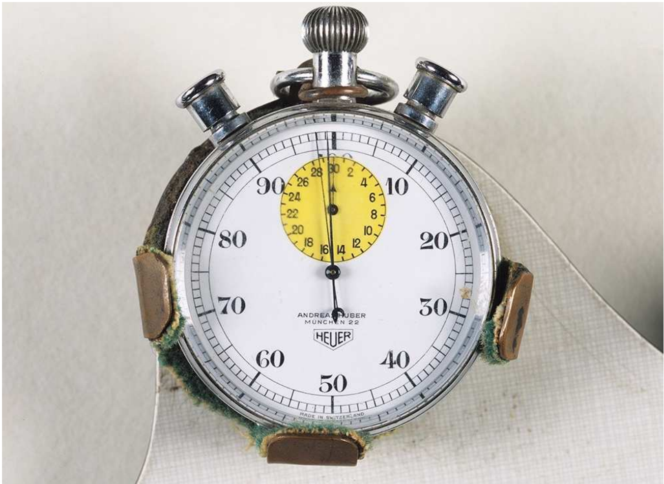
Abb. A1.19 REFA-Stoppuhr aus Metall und Glas, hergestellt zwischen 1960 und 1969 (LVR-Industriemuseum/Hoffmann o. J.).
