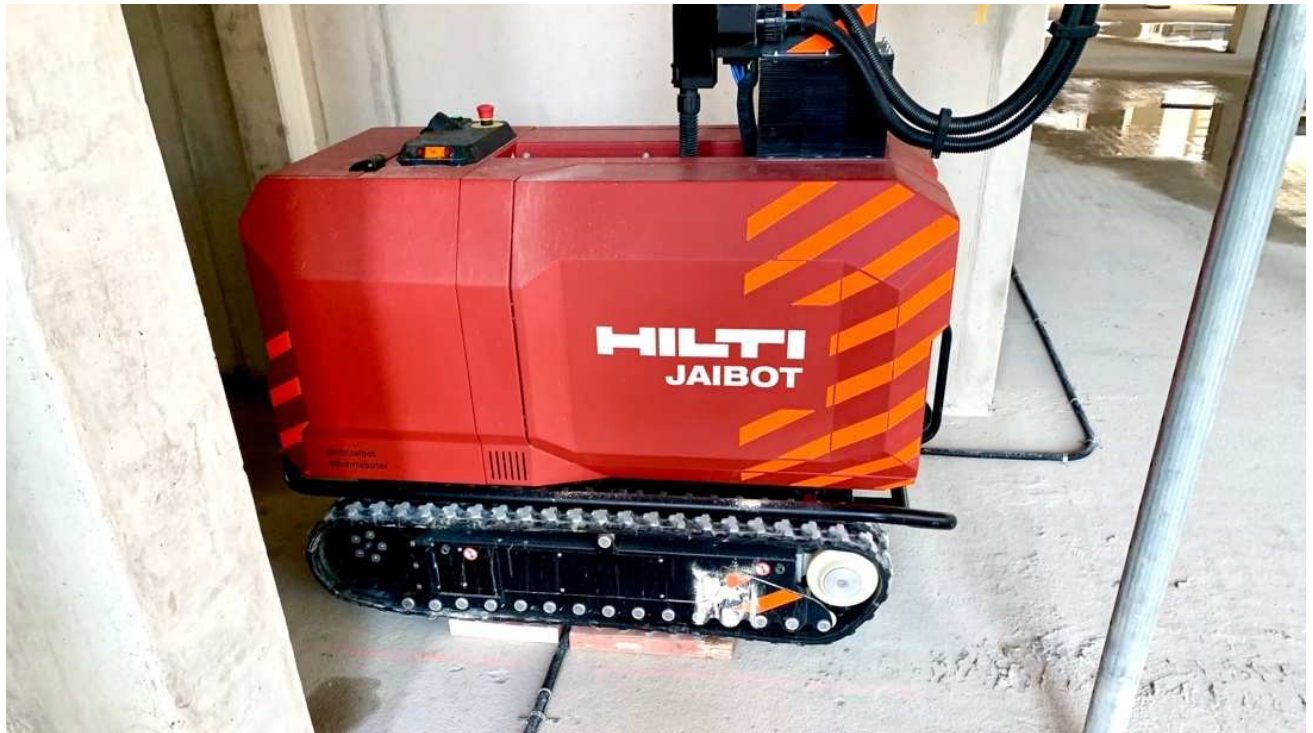
Abb. A1.4 Seitenansicht der Plattform des Jaibots mit Kettenantrieb (unten), der roten Plattform mit Bedieneinheit auf der Oberseite (mittig) und dem Ansatz des Bohrturms (rechts oben) (eigene Aufnahme).
