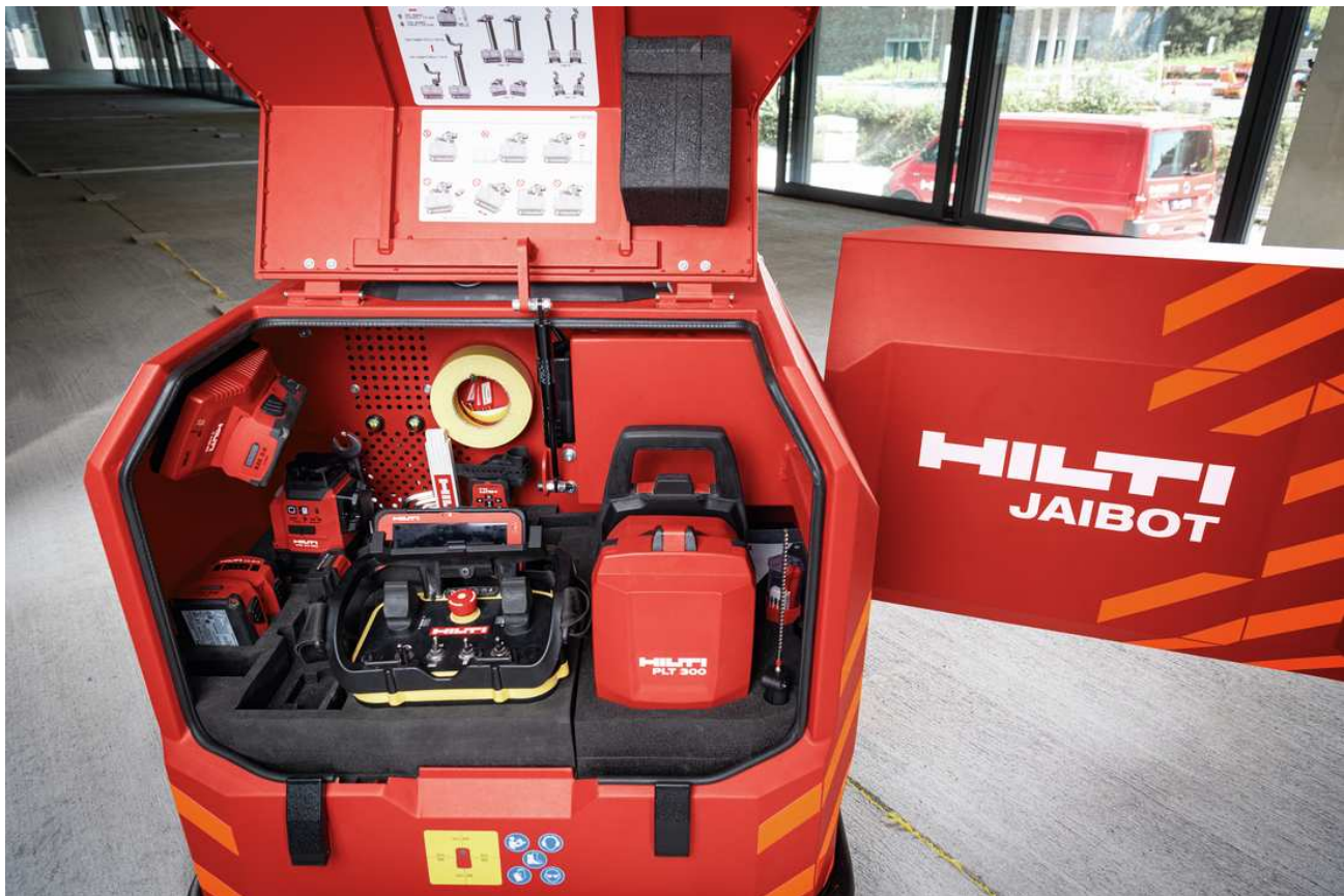
Abb. A1.6 Heckabteil (Akku Kompartiment) des Jaibots mit Ersatzakkus und Ladegeräten (links), Fernsteuerung und Tablet (mittig), sowie der PLT-Station (rechts) (Hilti Deutschland AG 2022).
