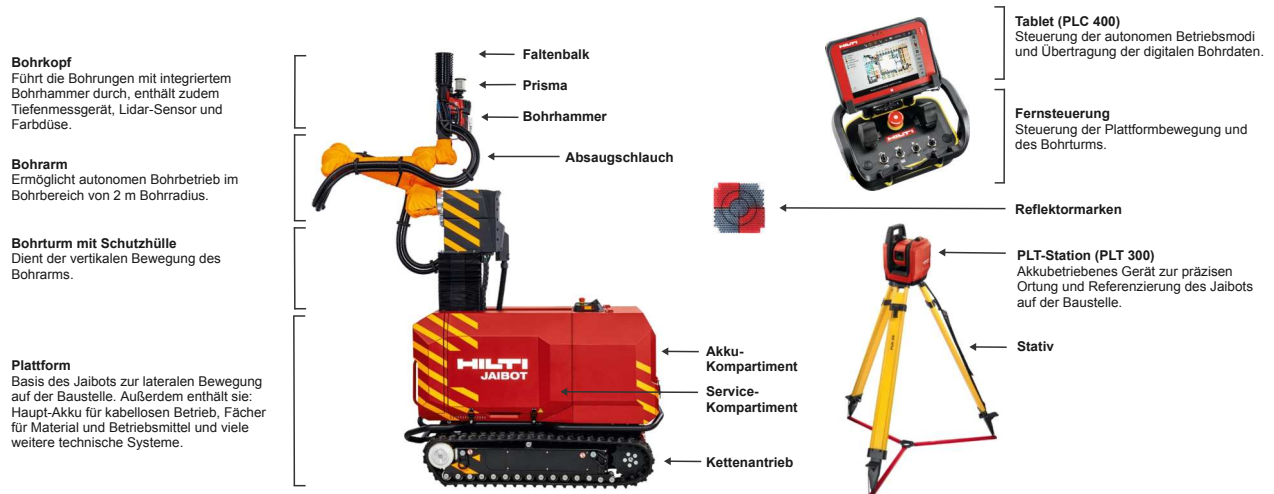
Abb. 2 Darstellung der Hauptkomponenten des Jaibots, basierend auf Bildmaterial der Hilti Deutschland AG (Hilti Deutschland AG 2022) in eigener schematischen Darstellung.
