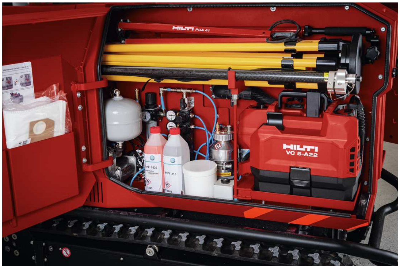
Abb. A1.5 Seitenabteil (Service Kompartiment) des Jaibots mit Kompressor- und Farbmarkierungssystem (links), Staubsauger (rechts), sowie Stativ für die PLT-Station und Messlanze (oben) (Hilti Deutschland AG 2022).
